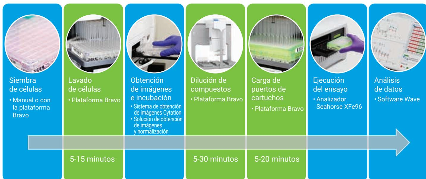
**Figura 5.** Flujo de trabajo general del ensayo Seahorse XF. Los pasos de preparación de muestras automatizados con la plataforma Bravo se muestran en verde: lavado de células, preparación de las soluciones de inyección y carga de los cartuchos de sensores Seahorse XFe96. El ahorro total de tiempo de preparación manual es de entre 20 y 60 minutos por placa.
